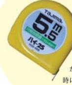
金属製の巻尺。幅は25mmか19mmがよい。狭い空間の計測時に引っ掛かる場合は細めの19mm、高い所は幅が太めの25mmならしっかり伸ばせる。ロック付きが便利。
