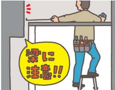
システムバスの点検口から採寸すると左のイラストのように梁にぶつかることがある。現場調査初心者の場合、梁までの寸法＝浴室の設置だと勘違いし小さいサイズを選びがちだが、よく見ると梁の下に空間が残っていることが分かる。梁加工すれば、サイズアップが可能な場合がある。
